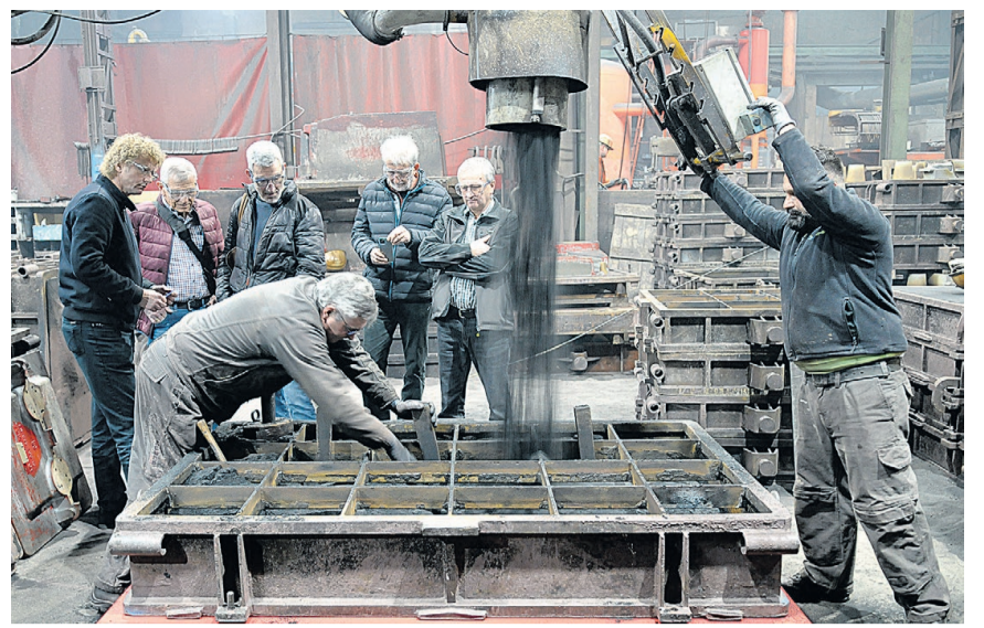
Füllen des Formkasten-Oberteils mit Kaltharz-Sand.
