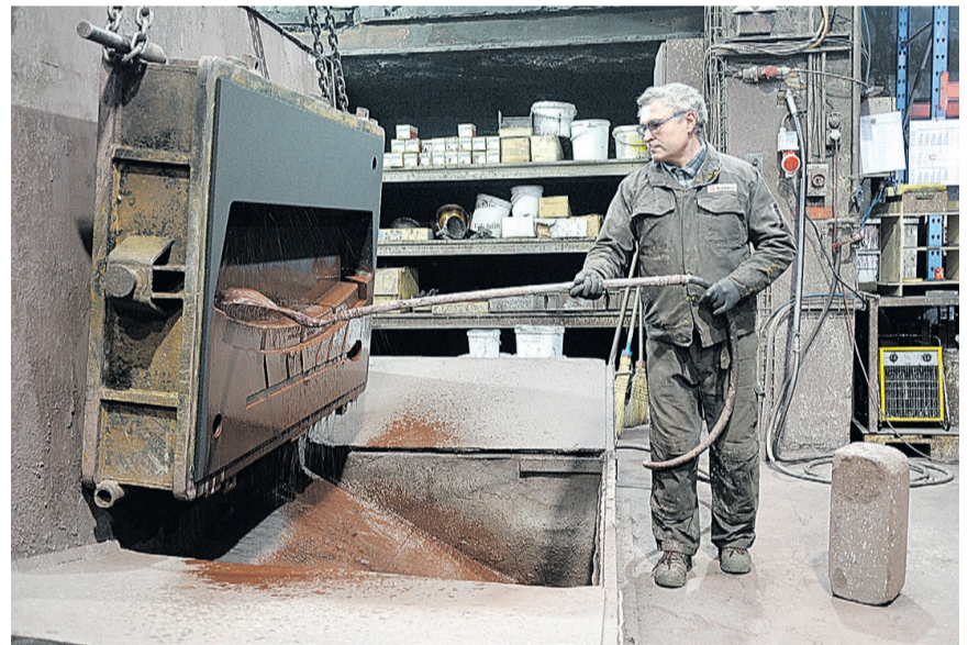
Das Form-Oberteil wird mit Schlichte geflutet.
