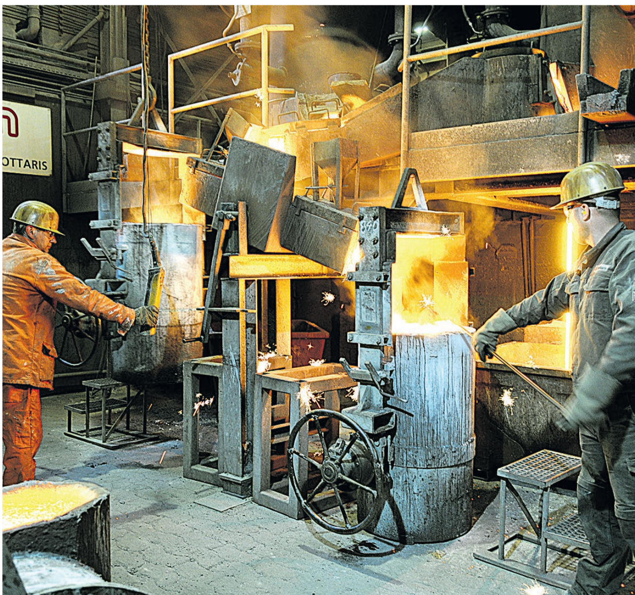
Einblick in den Schmelzbetrieb, mit den zwei Kaltwind-Kupolöfen.
